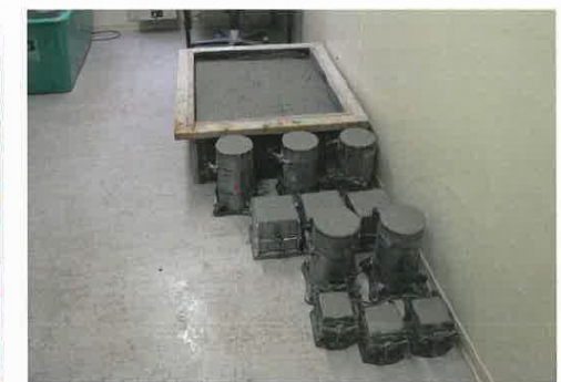
Bild 5: Herstellung zusätzlicher Probekörper für die Nachweise der ZiE
